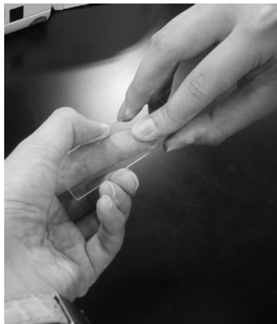
図 2-27 スライドガラスにはさんで粉末をすりつぶして分散させる
